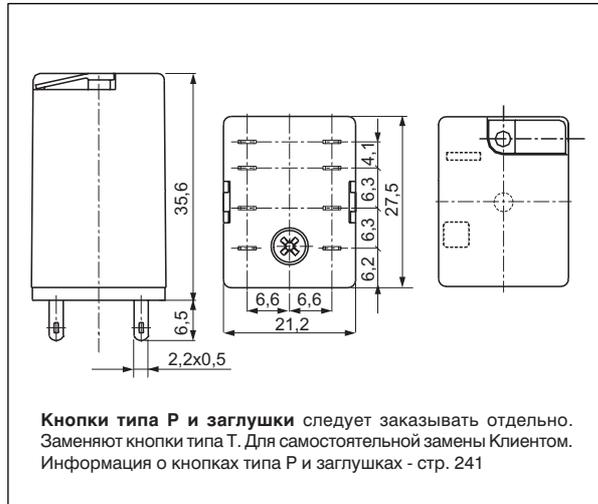
**Габаритные размеры** - исполнение для печатных плат (без WT)
