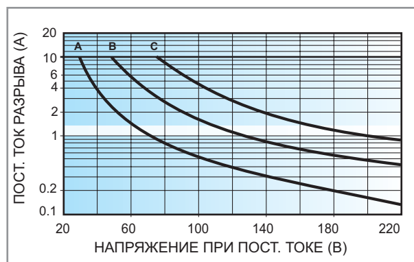
Отключающая способность при ном. нагрузке DC1
