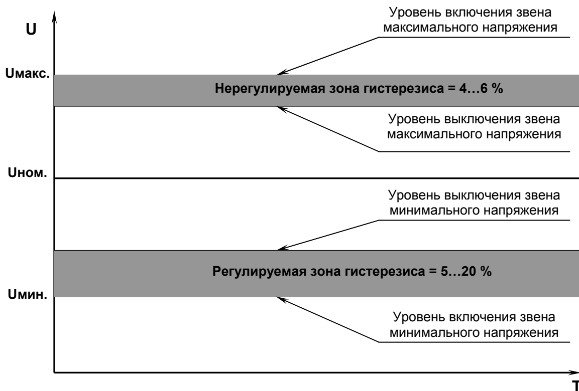
Рисунок 8 - Уровни включения / выключения звеньев максимального и минимального напряжений.
