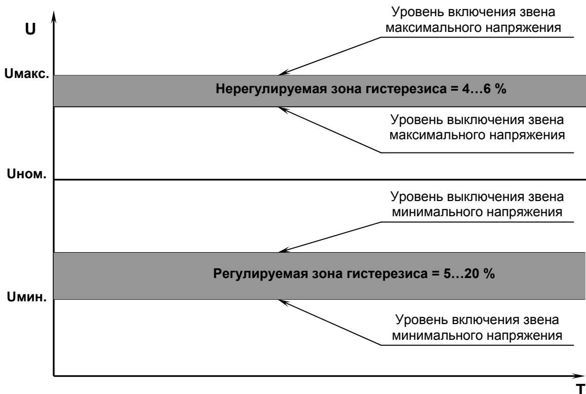
Рисунок 8 - Уровни включения/выключения звеньев максимального и минимального напряжений.
