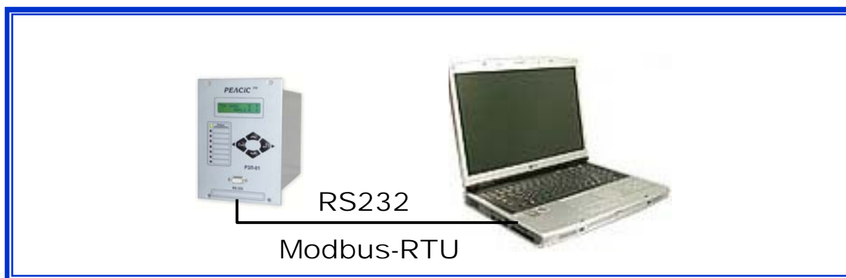
Рисунок 2 – Схема соединения устройства с компьютером.
