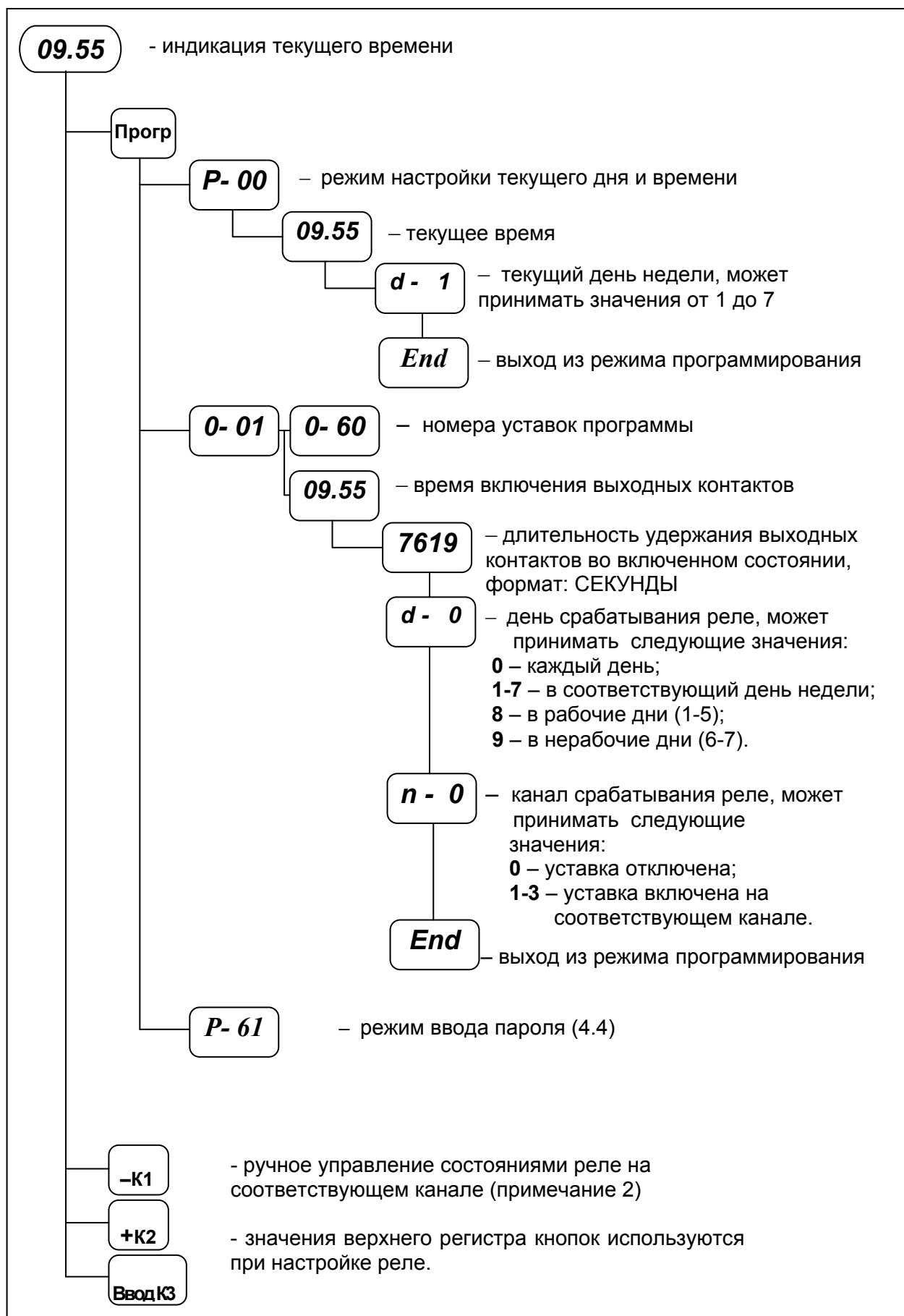
Рисунок 6 - Порядок настройки уставок реле РВЦ-03-22, РВЦ-03-24
