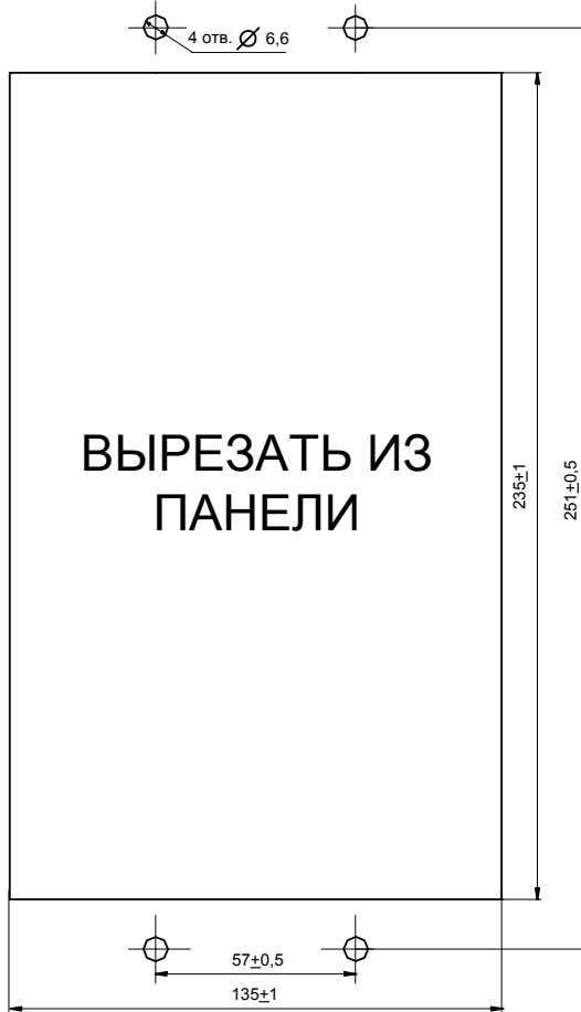
Рисунок А.12 Установочные размеры ТЭМП 2501-13
